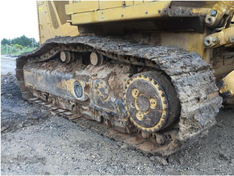
embargo, no se puede medir correctamente la distancia entre el rodillo inferior y el eslabón de la cadena. Por esta razón, el paso de la cadena se mide en la zona superior de los bulldozers. Para ello, hay que desplazar un poco la máquina hacia delante, de modo que la cadena alcance su paso máximo. Ahora utilice una regla para medir cuánto se hunde la cadena y ajustar en consecuencia. Consulte el manual de mantenimiento de su bulldozer. Allí se describe detalladamente este procedimiento.
