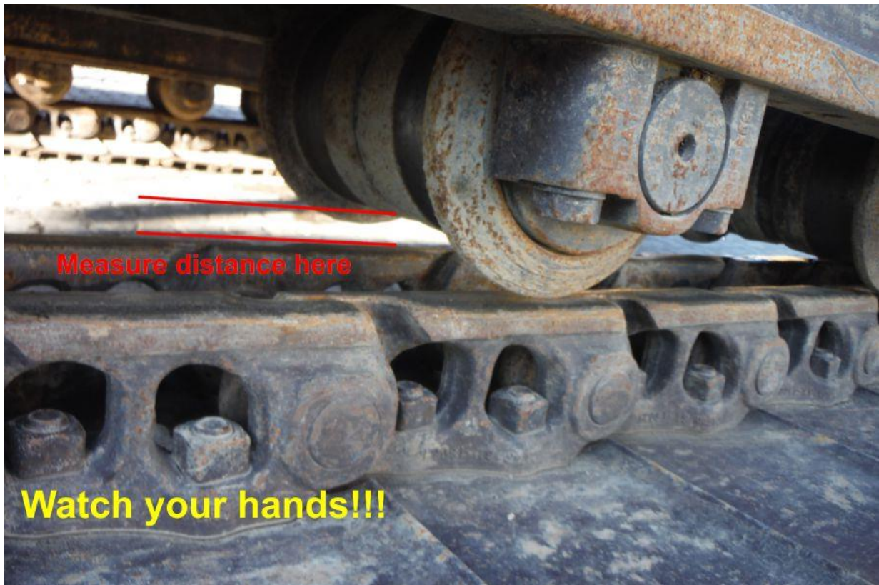
Foto 2: Distancia entre el rodillo y el eslabón de la oruga, Mida la distancia aquí
