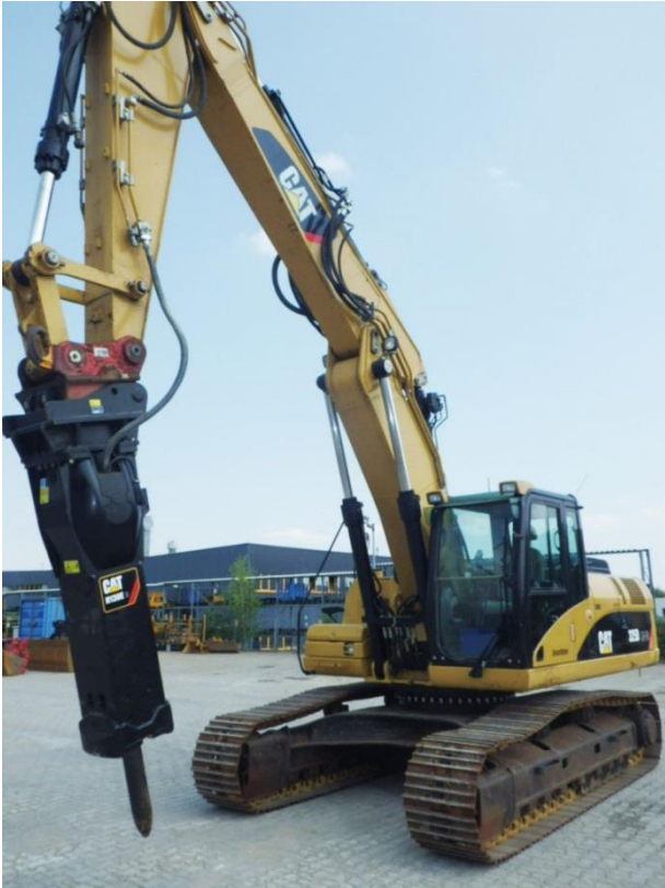
Excavadora Caterpillar con Martillo Hidráulico
