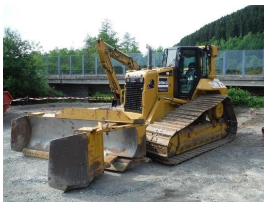
CAT D6N con Zapatas y Cuchilla Plegable
