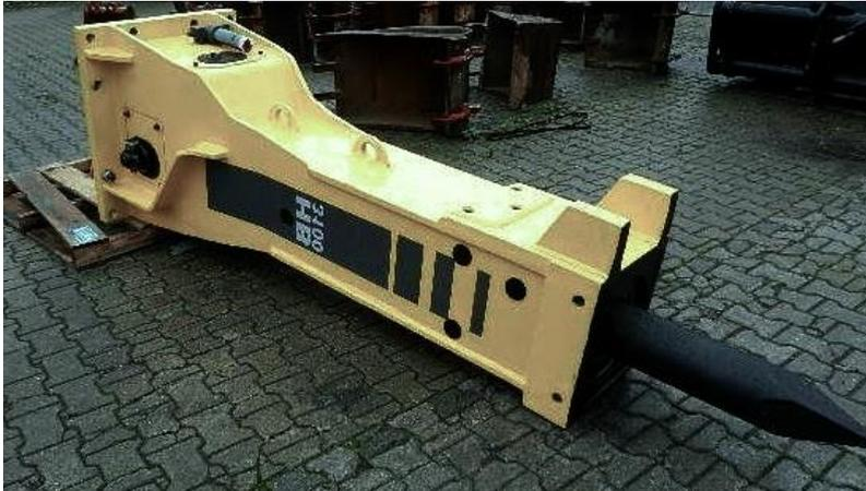
Adapter un marteau à une excavatrice au moyen d'un accouplement rapide est justifié si vous utilisez un accouplement résistant aux vibrations et à l'usure. Quelques accouplements, tels ceux de la marque Verachtert, sont une bonne référence.
