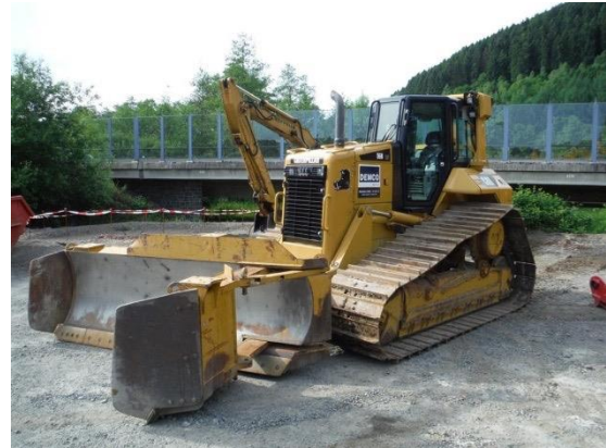
CAT D6N avec chenilles LGP et lame articulé
