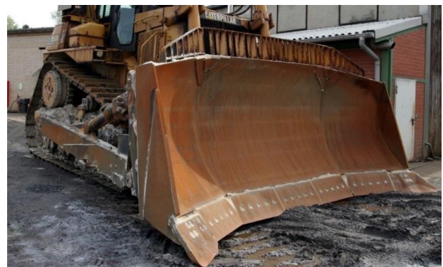
Lame en U d'un CAT D10T
