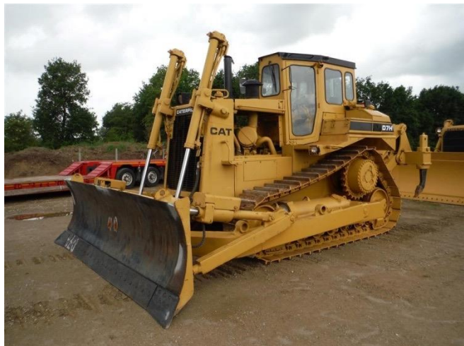
Tracteur Caterpillar DH7 avec lame droite en S
